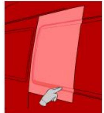
11. Controllare l'applicazione cercando eventuali bolle rimaste. Se si dovessero vedere ancora delle piccole bolle d'aria, queste possono essere rimosse facilmente. Praticare un piccolo foro, riscaldarlo (40-50 °C) e far uscire l'aria schiacciando.
