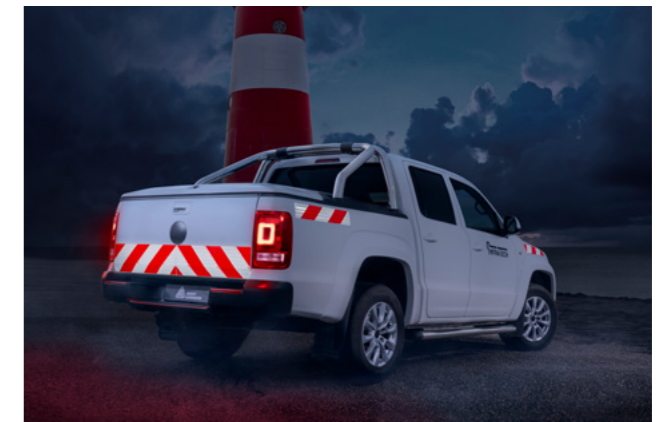
Chevrons réfléchissants Blanc/Rouge Avery Dennison pour le marquage de véhicule, en conformité avec les normes DIN30710 et TPESC-B.
