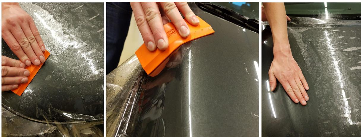
Lorsque vous utilisez les films Avery Dennison Pure Defense PU et PVC, le repositionnement du film est uniquement possible au stade du positionnement initial avec une faible pression de la raclette, voire sans pression du tout. Si le repositionnement est effectué à une étape ultérieure, de petites marques ou lignes pourraient rester visibles dans la surface du film.
