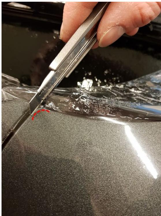
Pour faciliter la découpe, assurez-vous d'utiliser des couteaux neufs et très tranchants : les couteaux émoussés produiront des bords de découpe flous. Pendant la pose des films Avery Dennison Pure Defense PU et PVC, il est recommandé d'utiliser des lames en acier inoxydable avec votre cutter. L'utilisation de lames en acier inoxydable permettra de retarder la rouille et la détérioration des lames, dues au contact avec l'eau.
