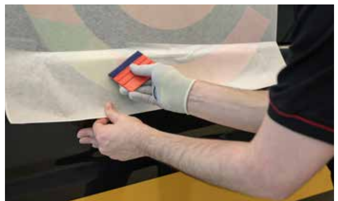
Usando Paper 300- High Tack par aplicar material reflectante impreso de rotulación V-400
